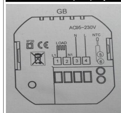
1 и 2 — подключение термоплёнки;
