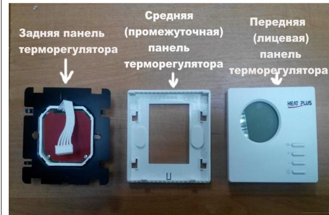
Этот терморегулятор монтируется на стену в стандартный подрозетник 60 мм.
