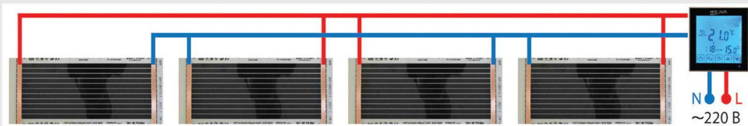
Соединение проводов произвести методом пайки к медным шинам пленки (см. рис. 5б) и вывести к терморегулятору так, как указано на схеме, **либо** закрепить **клипсы-коннекторы** на медной шине пленки с помощью **Пресса**, и подключить провода к коннекторам (см. рис. 5а).
