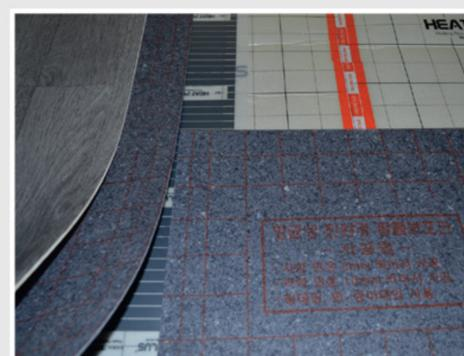
Под легкие гибкие покрытия (линолеум, ковролин и т. п.) настоятельно рекомендуем использовать защитный теплораспределяющий слой **E-STONE**. Он укладывается поверх пленки и соединяется между собой термостойким скотчем.
